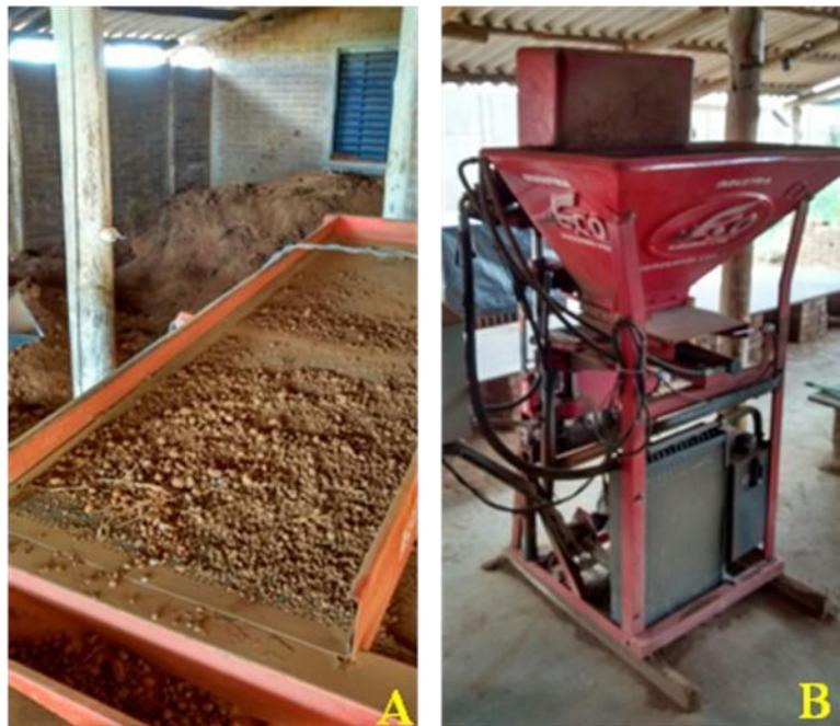
**Figura 3:** Maquinário da fábrica de tijolos ecológicos na ONG Ação Moradia (A e B).
