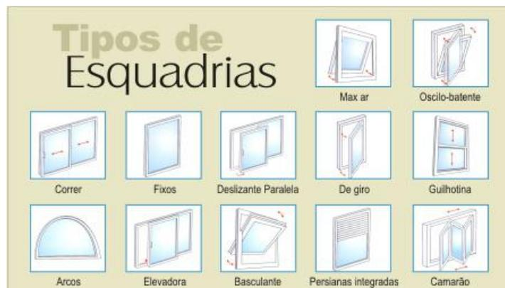
O projeto específico das esquadrias se faz importante por ser um projeto detalhado que além de atender ao projeto arquitetônico da edificação, serve como base para fabricação e montagem das peças e instalação do produto. Sendo assim, é dividido em três fases: Estudo preliminar, anteprojeto e projeto executivo.
